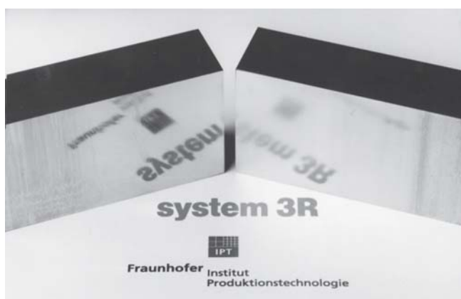
Slika 5: Primerjava kvalitete obdelane površine na dušenem sistemu (levo) in nedušenem sistemu (desno).
