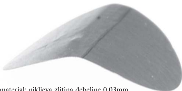
material: nikljeva zlitina debeline 0,03mm
